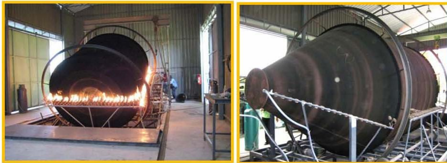
แม่พิมพ์หมุนในระหว่างการขึ้นรูปไซโลพลาสติกขนาด 20 ลูกบาศก์เมตร
