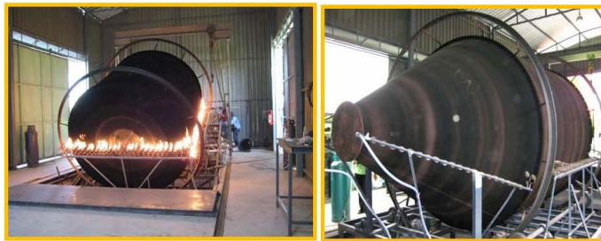
แม่พิมพ์หมุนในระหว่างการขึ้นรูปไซโลพลาสติกขนาด 20 ลูกบาศก์เมตร
